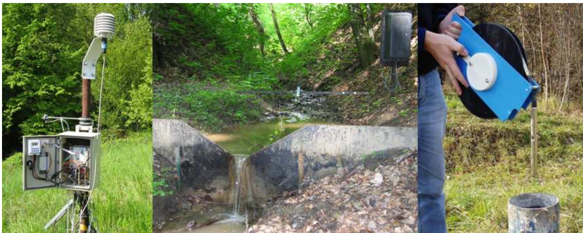
Obr. 2.5 Zleva: telemetrická stanice Minicube VC, přeliv (autor: Studená, 2010), hladinoměr G20 (zdroj: http://geohydro.upol.cz )
