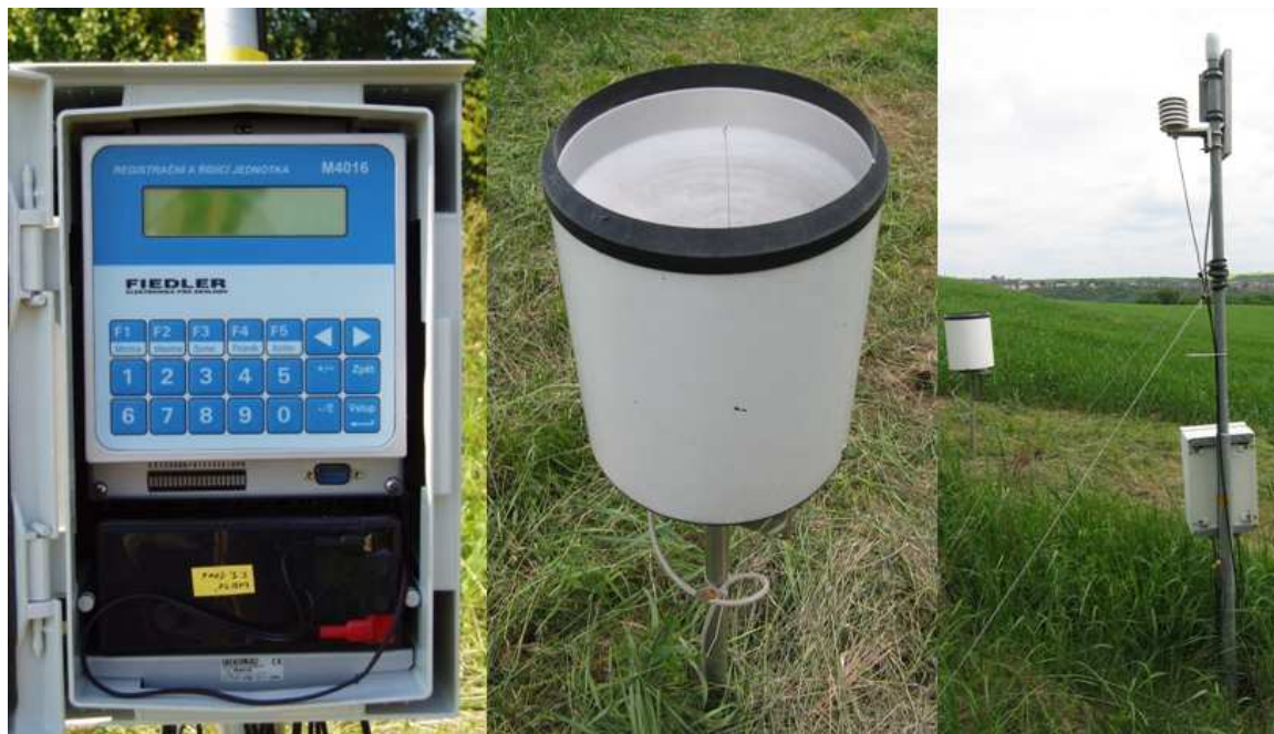
Obr. 2.2 Zleva: telemetrická stanice M4016 (zdroj: http://geohydro.upol.cz ), srážkoměr SR03, teplotní snímač Pt100 v krytu (autor: Studená, 2010)
