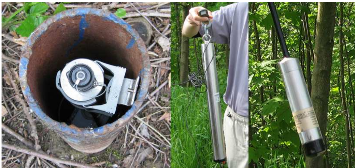
Obr. 2.3 Zleva: vrt JP-9, malá telemetrická stanice Stela, tlakové čidlo typu LMP od firmy BD Sensors (autor: Studená, 2010)
