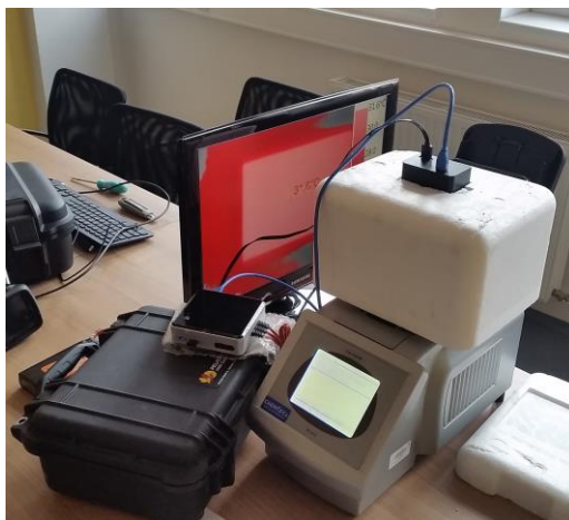
Obr. č. 6: Sestava pro testování kamery Workswell Thermal Vision (zdroj: autor)
