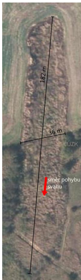
Obr. 16 Ortofotosnímek proudového sesuvu „Nad firmou“ (WMS poskytované ČÚZK, dostupné z: http://geoportal.cuzk.cz/ , upraveno).
