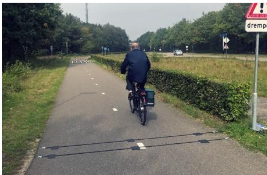
Obr. 8 Trubkový sčítač na cyklostezce (zdroj: Metrocount.com)
