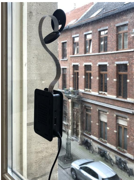
Obr. 9 Uchycení senzoru Telraam v1 na okno (zdroj: https://telraam.net/ )
