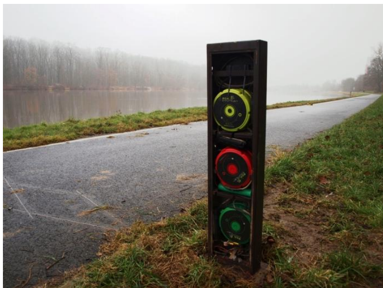
Obr. 7 Indukční smyčka se sčítacím zařízením (zdroj: https:// kr-ustecky.cz )
