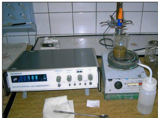
Obr. 3.3 Digitální pH-metr MV 870
