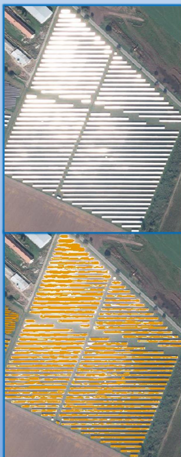
Obr. 3 Vliv na kvalitu výstupních dat má do jisté míry i vstupní ortofoto (např. odraz slunečních paprsků od panelů)
