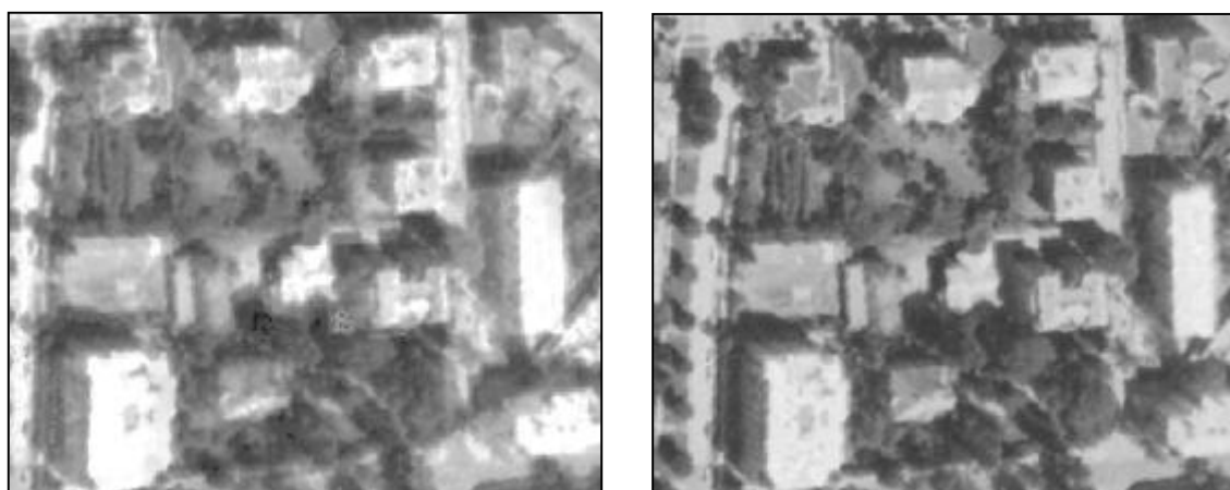
Obr. 7 Porovnání snímků (rok 1994) - mozaika (vlevo) a samostatný snímek (vpravo) v měřítku 1:1 000.
