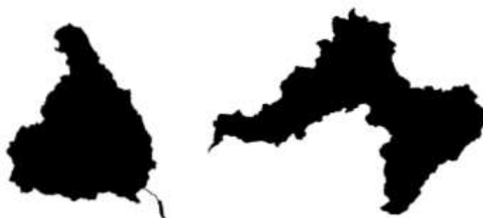
Obr. 11.2 Vlevo povodí PDY6 (hodnota Perimeter-Area Ratio 3,3), vpravo povodí PMO9 (hodnota Perimeter-Area Ratio 3,2)
