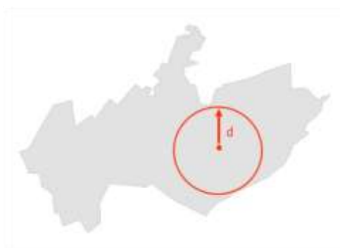
Obr. 7.9 Princip výpočtu girth indexu (autor: J.Parent, 2009).
