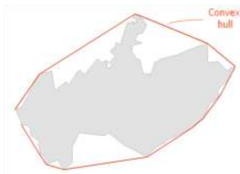
Obr. 7.8 Princip výpočtu detour indexu (autor: J.Parent, 2009).
