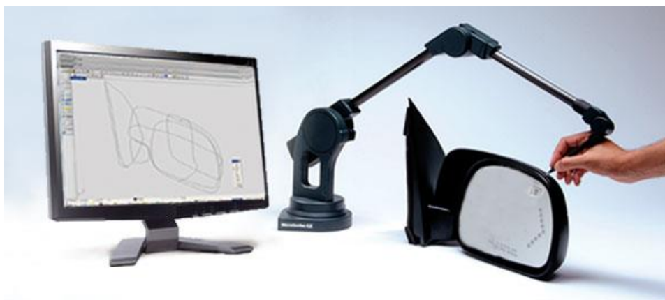
Obr. 2 Kontaktní skener MicroScribe (zdroj: http://www.picasoft.com/ ).
