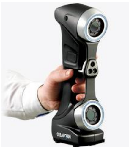
Obr. 4 Mobilní ruční skener HandyScan (zdroj: http://www.creaform3d.com/ ).
