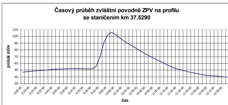
Obr. 15: Hydrograf profilu se staničením 37.5290
