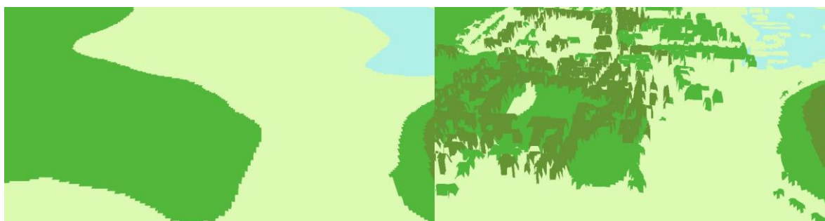
Obr. 3: Rozdíl mezi DTM (vlevo) a DSM (vpravo)
