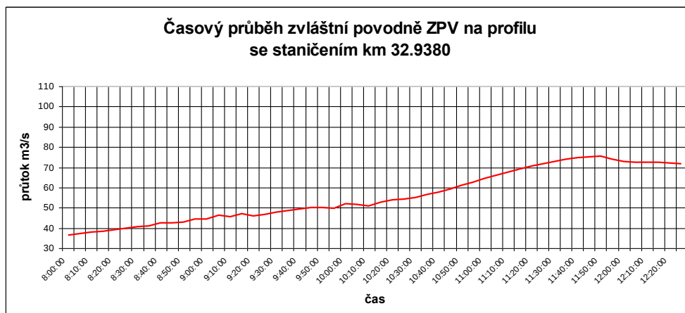
Obr. 18: Hydrograf profilu se staničením 32.9380
