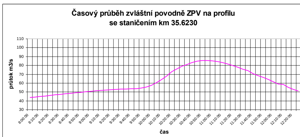
Obr. 17: Hydrograf profilu se staničením 35.6230
