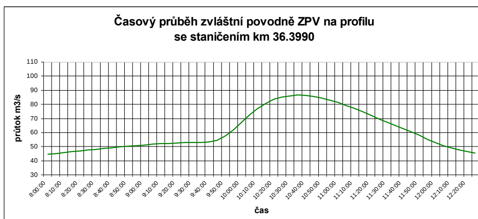
Obr. 16: Hydrograf profilu se staničením 36.3990
