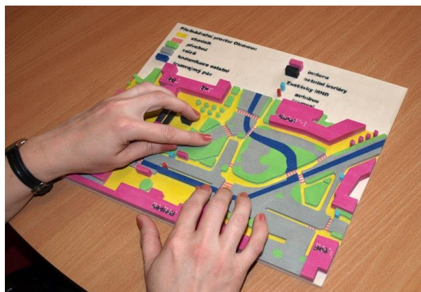
Obr. 3.2 Tyflomapa olomouckého přednádraží vyrobená metodou 3D tisku (zdroj: http://www.zurnal.upol.cz/uploads/pics/tyflomapy.jpg ).
